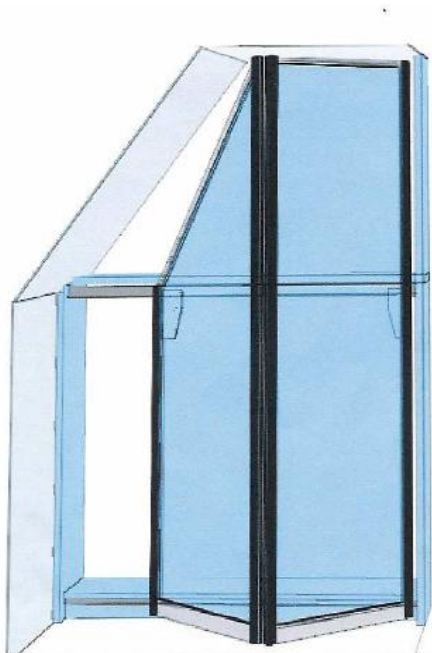
Obr.5. Vrchná koľajnica je montovaná na policu.
